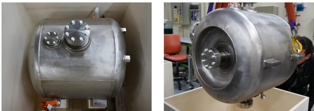
Figure 10 : Les deux prototypes de cavité Spoke pour MYRRHA ; Amelia (ZA01) et Virginia (ZA02).
